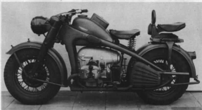
Hier wird die enorme Bodenfreiheit des Zündapp KS 750-Gespanss sichtbar, sie betrug unter dem Seitenwagen 290 mm und die Watfähigkeit belief sich damit auf stolze 425 mm. Der fast konkurrenzlosen Geländegängigkeit und Wendigkeit der KS 750 und der BMW R 75 stand indessen ein hoher Fertigungsaufwand und damit ein Preis, der das Doppelte eines VW-Kübelwagens ausmachte, entgegen. Es sind jedoch von 1941 bis 1945 insgesamt etwa 35.000 Exemplare gebaut worden.
