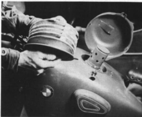
Links: Hier ist der sogenannte Tropen-Filter an der R 75 im Detail zu sehen. Der ursprünglich auf dem Motorblock untergebrachte Filter setzte sich viel zu schnell zu, so daß man zu dieser Modifikation gezwungen war.
