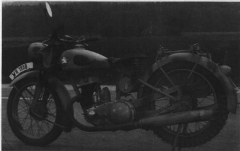
Links: Die Triumph S 350 noch einmal von der Antriebsseite, es wurde für die Wehrmachtverwendung lediglich eine Packtaschen-Halterung angebaut und das ganze Fahrzeug umlackiert.
